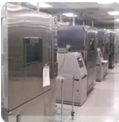
Ispitni laboratorij Laboring d.o.o., zatražio je proširenje područja akreditacije za ispitivanje temperaturnih komora u 9 prostornih točaka prema zahtjevima norme IEC 60068-3-5:2001.
